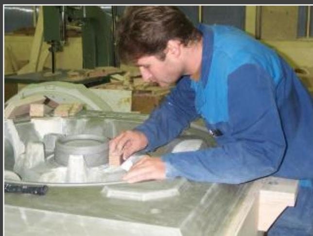
*Rectification d'un moule en aluminium*
