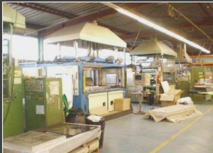
*Ligne de thermoformeuses ILLIG & SHELLEY*
