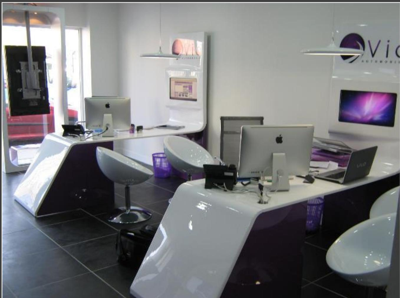
*Mobilier VIA automobile, bureau et support d'écrans en ABS plaxé PMMA 5 mm thermoformé*
